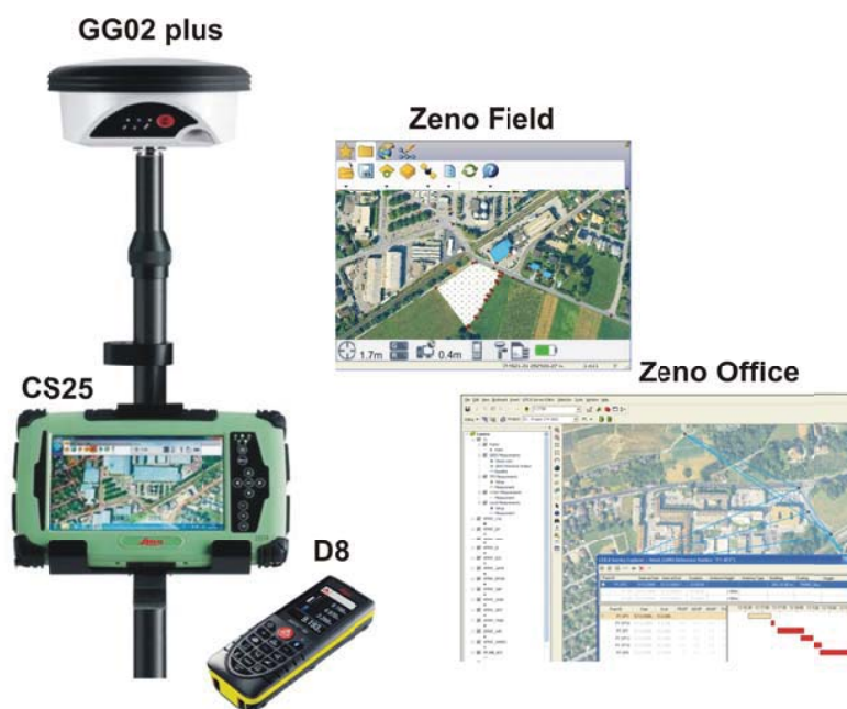
Рис. 5. Состав комплекса Leica Zeno GIS
